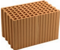
Erdbebensicheres Bauen und bei besonders hohen Anforderungen an die Tragfähigkeit, z. B. Innenwand Rohdichteklasse 0,9 f_k = 5,0 (SFK 12) bis 6,8 MN/m 2 (SFK 20) \lambda = 0,39 bis 0,58 W/mK (nach RDK) Wanddicken t = 17,5 / 20 / 24 / 30 cm
