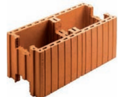
Schalungsziegel für Wohnungs- / Haustrennwände zum Verfüllen mit fließfähigem Beton C12/15, Körnung 0-16 mm mit oder ohne Horizontal- / Vertikalbewehrung R_{w,2}^{(2)} = 57 dB ( t = 17,5 cm) R_{w,2}^{(2)} = 61,4 dB ( t = 24 cm) R_{w,2}^{(2)} = 64,4 dB ( t = 30 cm)
