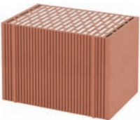
Füllung: Perlite-Dämmstoff \lambda = 0,09 \text{ W/mK} R_{w,1} \geq 50 \text{ dB} f_k = 5,3 \text{ MN/m}^2 (bei SFK 12)
