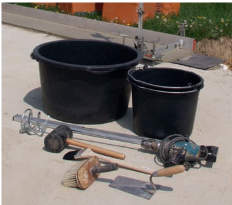
Werkzeug für die Verarbeitung von Planziegeln
